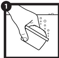
Plaats het filter in een kom met koud kraanwater, duw voorzichtig naar beneden in een hoek tot het filter onder water is en luchtbellen vrijkomen. Laat het staan gedurende 10 minuten.
