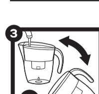
Setzen Sie den Trichter wieder ein und füllen Sie die Kanne mit kaltem Wasser. Filtern und entsorgen Sie das gefilterte Wasser anschließend. Wiederholen Sie diesen Schritt noch zweimal.
