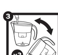
Replacer le couvercle et remplir avec de l'eau froide, laisser l'eau filtrer avant de jeter l'eau. Renouveler l'opération encore deux fois.
