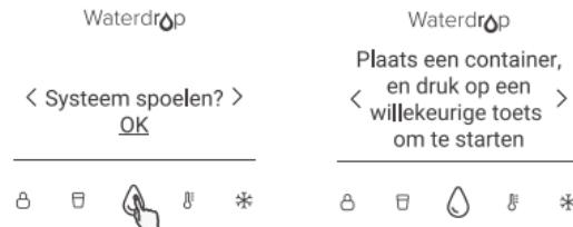
**Stap 3:** De dispenser filtert en doseert automatisch water tijdens het spoelen. Tik op een willekeurige toets op de interface om het proces te pauzeren. Om te hervatten tik je op de bevestigingstoets "OK".
