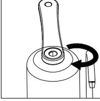
Skruva filterhuset i basen för hand och dra åt det med nyckeln.
