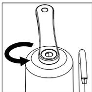
Setzen Sie das System in das Spülbecken und verwenden Sie den Schraubenschlüssel, um das Filtergehäuse von oben zu lösen (es wird Wasser zwischen dem Filtergehäuse und der Basis geben).
