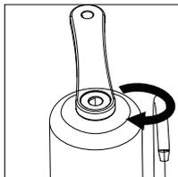
Schroef de filterbehuizing met de hand in de basis en draai hem vast met de sleutel.
