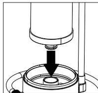
Wyjmij przeterminowany filtr ze systemu i wstaw nowy filtr do podstawy. Upewnij się, że pierścień uszczelniający został zamontowany mocno.
