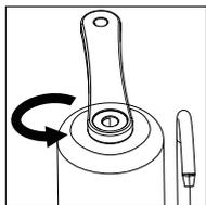
Posizionare il sistema nel lavandino e utilizzare la chiave per svitare il contenitore del filtro dalla parte superiore (ci sarà acqua tra il contenitore del filtro e la base).
