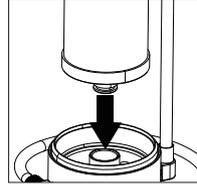
Ta bort det utgångna filtret från systemet och sätt in det nya filtret i basen. Se till att tätningen är installerad ordentligt och att plastfilmen på det nya filtret har tagits bort.
