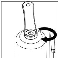
Schrauben Sie das Filtergehäuse von Hand in die Basis und ziehen Sie es mit dem Schraubenschlüssel fest.
