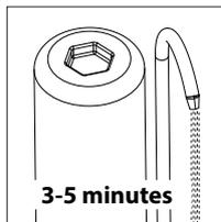
Schalten Sie den Wasserhahn ein und spülen Sie den neuen Filter 3-5 Minuten lang aus.
