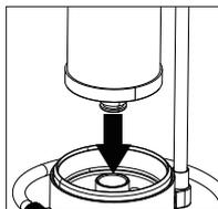
Rimuovere il filtro scaduto dal sistema e inserire il nuovo filtro nella base. Assicurarsi che la guarnizione sia stata installata saldamente e che la pellicola di plastica del nuovo filtro sia stata rimossa.
