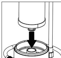
Entfernen Sie den abgelaufenen Filter aus dem System und setzen Sie den neuen Filter in die Basis ein. Stellen Sie sicher, dass der Dichtungsring fest installiert ist und die Kunststoffolie des neuen Filters entfernt wurde.
