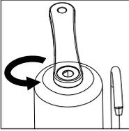
Sistemi lavabo içine yerleştirin ve filtrenin üstünden anahtar kullanarak filtre kutusunu sökün (filtre kutusu ile taban arasında su olacaktır).
