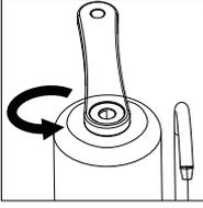
Placera systemet i diskhon och använd nyckeln för att skruva loss filterhuset från toppen (det kommer att finnas vatten mellan filterhuset och basen).
