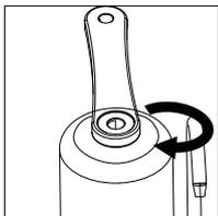
Vissez le boîtier de filtre dans la base à la main et serrez-le avec la clé.
