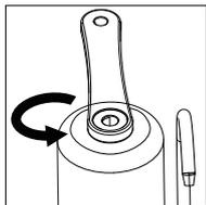
i wymiany Umieść system w zlewku i użyj klucza do odkręcenia obudowy filtra z góry (między obudową filtra a podstawą znajdzie się woda).
