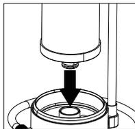
Retire el filtro caducado del sistema e inserte el nuevo filtro en la base. Asegúrese de que el anillo de sellado esté instalado firmemente y se haya retirado la película de plástico del nuevo filtro.
