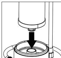
Retirez le filtre expiré du système et insérez le nouveau filtre dans la base. Assurez-vous que le joint d'étanchéité est installé fermement et que le film plastique du nouveau filtre a été retiré.
