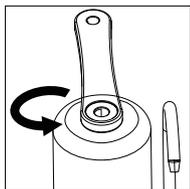
vervangingsprocedures Plaats het systeem in de gootsteen en gebruik de sleutel om de filterbehuizing van bovenaf los te draaien (er zal water tussen de filterbehuizing en de basis zijn).
