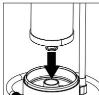
Verwijder het verlopen filter uit het systeem en plaats het nieuwe filter in de basis. Zorg ervoor dat de afdichting stevig geïnstalleerd en de plastic folie van het nieuwe filter is verwijderd.
