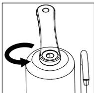
Placez le système dans l'évier, et utilisez la clé pour dévisser le boîtier de filtre du haut (il y aura de l'eau entre le boîtier de filtre et la base).
