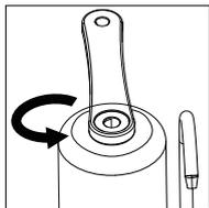
y reemplazo Coloque el sistema en el fregadero y use la llave para desenroscar la carcasa del filtro desde la parte superior (habrá agua entre la carcasa del filtro y la base).
