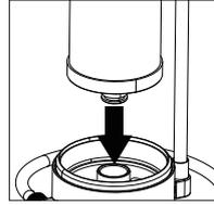
Sisteme takılı olan eski filtreyi çıkarın ve yeni filtre kutusuna yerleştirin. Conta halkasının sağlam bir şekilde takıldığından ve yeni filtre kutusunun plastik filmi çıkarıldığından emin olun.
